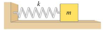
Figura 8.18 Un blocco è attaccato a una molla su un piano senza attrito. Se scegliete come sistema il blocco e la molla, allora E = 1/2mv^2 + 1/2kx^2 si conserva.
