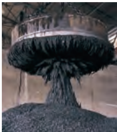
Figura 28.1 L'uso di un elettromagnete per la raccolta e il trasporto dei metallici in un'acciaieria.
