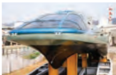
Figura 28.10 Lo Yamato-1 era una nave in dimensioni reali azionata per effetto magnetoidrodinamico.
