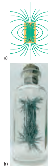
Figura 28.4 a) Le linee del campo magnetico di una barra magnetica. b) Una «calamita per bovini», una barra magnetica che viene introdotta nel ruminale delle mucche per impedire che pezzetti di ferro ingeriti accidentalmente raggiungano l'intestino dell'animale. L'orientazione dei filamenti di ferro alle estremità della calamita rivela la direzione delle linee del campo magnetico.
