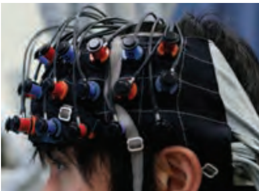
Figura 34.27 Nella spettroscopia funzionale nel vicino infrarosso ( functional Near-Infra-Red-Spectroscopy , fNIRS) una persona indossa uno stretto copricapo con un certo numero di LED che emettono luce nell'intervallo del vicino infrarosso. La luce può penetrare nello strato esterno del cervello e rivelare quale area è attivata da una data attività, dal giocare a baseball al pilotare un aereo.
