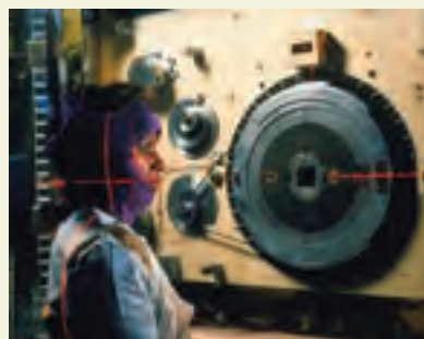
Figura 28.18 Essendo invisibile, un fascio di neutroni dall'uscita alla destra è allineato tramite mirini laser, visti sovrapposti al paziente.
