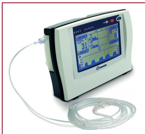
Fig. 115.2 Sistema di monitoraggio dell'ETCO 2 (RespSense ETCO 2 ). Dispositivo widescreen touch-screen che consente la visualizzazione in tempo reale del tracciato capnografico, dei valori numerici di ETCO 2 e della frequenza respiratoria. È dotato di allarmi audiovisivi e di funzioni di registrazione dei dati.
