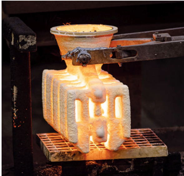
Figura 3.2 Conchiglia ceramica “a grappolo” per fusione a cera persa durante la cottura. (Per gentile concessione Device Med)
