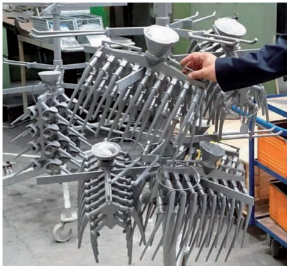
Figura 3.3 Grappoli di steli per artroprotesi di anca ottenuti per fusione a cera persa. Notare su ciascun grappolo il sistema di distribuzione della colata. (Elaborata da Spotlightmetal.com).
