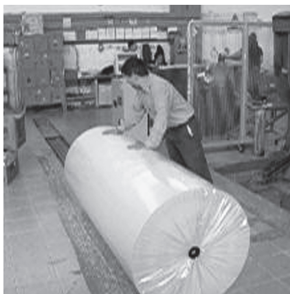
Fig. 3.2 – La movimentazione manuale dei gravi (azione di spinta di un grave dal peso ingente) in un bobinatore dell'industria della carta
