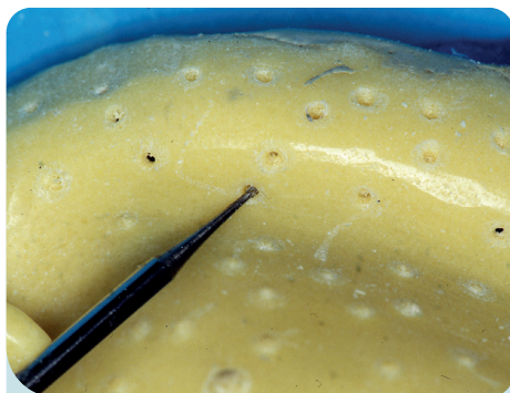
Figura 62 Se i fori vengono creati dall'interno verso l'esterno risulteranno più grandi e possono creare bolle sul modello master
